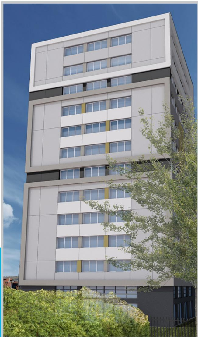
Le chantier démarrera fin 2021. Le programme de travaux de réhabilitation comporte l'isolation extérieure, le remplacement des menuiseries et des volets roulants, la réfection complète de la ventilation mécanique contrôlée et enfin la réfection complète des étanchéités terrasses.
